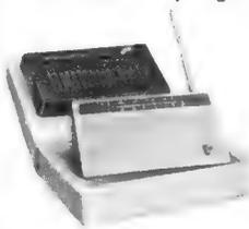
Der Kleinstempfänger für den KW-Amateur! 2 KW-Bereiche, 7,3 bis 3 MHz u. 22—9,5 MHz und 1 MW-Bereich 1605—525 kHz, 5 Kreise, 6 Transistoren, 6 V = 4 Mignon-Zellen, Abmessungen 175 x 106 x 44 mm.
